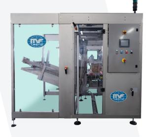
Il magazzino può essere automatico o a gravità, consente l'apertura e la formazione del cartone in modo completamente automatico. La presa del cartone dal magazzino avviene tramite ventose, montate su un braccio a movimento meccanico. Il cartone viene tenuto da un sistema dotato di ventose anche durante la piegatura dei lembi inferiori anteriori e posteriori, consentendo una maggiore precisione.
