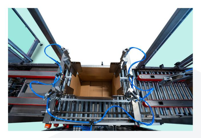
L'introduzione dei prodotti nella scatola può avvenire in modo automatico (tramite un sistema Pick and Place) o manuale. Il sistema di apertura lembi è personalizzabile in maniera automatica o semi automatica e garantisce il centraggio della scatola al momento dell'inserimento tramite pick and place.
