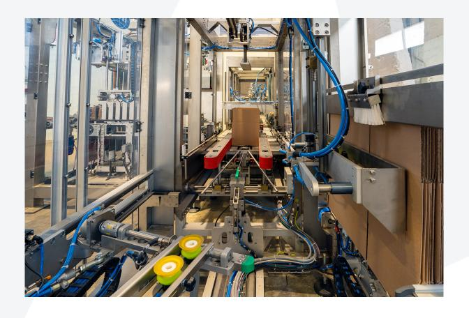
La scatola in arrivo su una rulliera viene centrata, chiusa inferiormente e trascinata verso l'unità sigillatrice garantendo il perfetto mantenimento della forma. La chiusura può essere effettuata a nastro adesivo, con colla a caldo (Hot Melt) o entrambi.
