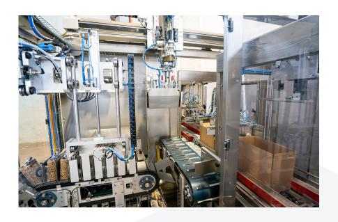
La **Cartonatrice MF CUBE** è una macchina di ultima generazione in grado di formare, riempire e chiudere scatole americane (anche dette RSC). Qualsiasi tipo di prodotto può essere riposto all'interno della scatola tramite carico dall'alto o da carico laterale (carico frontale).
